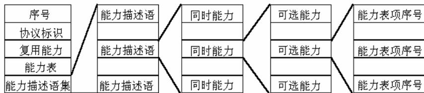
图4-1 终端能力集数据结构
